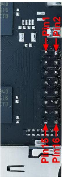
图 16: GPIO 扩展接口引脚定义图。图中展示了主板的GPIO扩展接口，共有16个引脚。引脚1至15分别对应表16中的定义。引脚15和16被标注为Pin15和Pin16，且图中有红色箭头指向它们。图中还显示了其他引脚的标注，如Pin1和Pin2。
